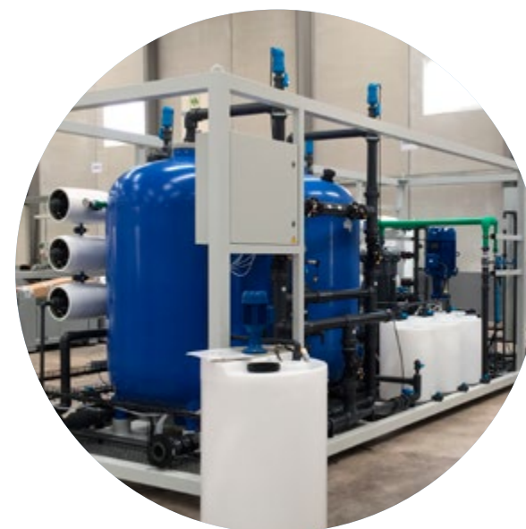
Spanyolország Almería. Sierra de los Filabres Ásványi sók eltávolítása 1 - 15 m 3 /h (10 db)
